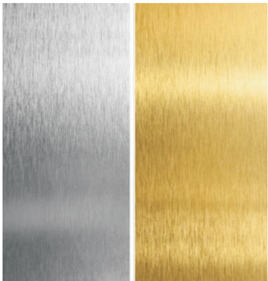
Material der Figuren und der Brunnenverkleidung: Edelstahl gebürstet und Messing 2,0mm stark
