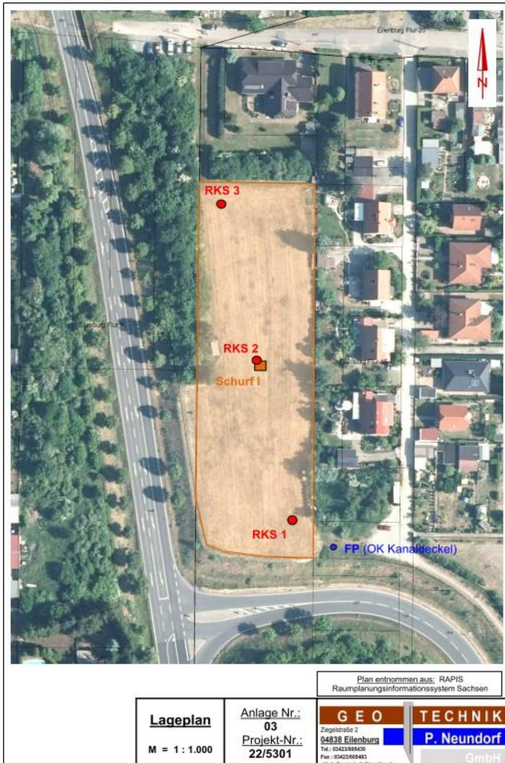
Abbildung 6: Lageplan Rammkernsondierungen im Vorhabengebiet (ohne Maßstab)
